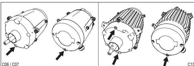
Fig. 2: Emplacement des trous de drainage du condensat
