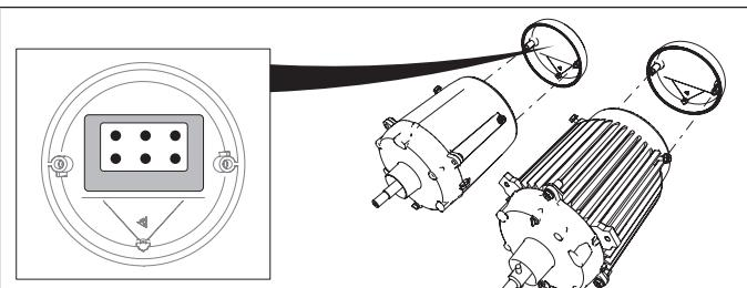
Fig. 4: Emplacement du schéma de branchement
