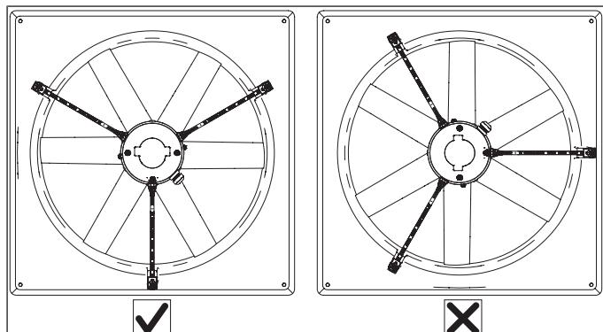
Fig. 3: Trou de drainage des condensats à la position la plus basse possible
