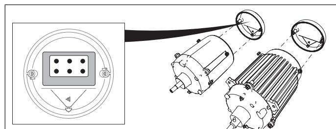
Afbeelding 4: Locatie van het aansluitschema
