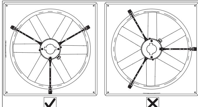
Abb. 3: Kondensat-Abflussloch an tiefstmöglicher Stelle
