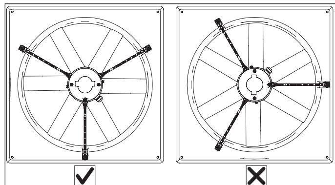
Afbeelding 3: Condensaataafvoergat op de laagst mogelijke positie
