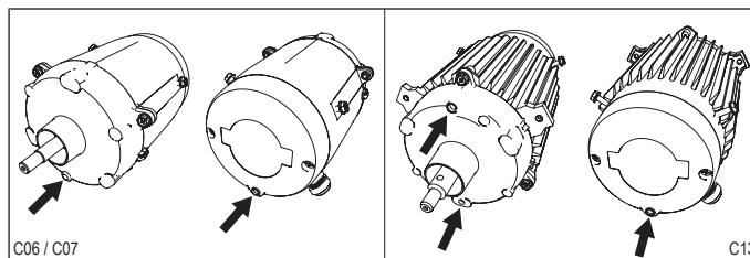
Abb. 2: Positionen der Kondensatablauflöcher
