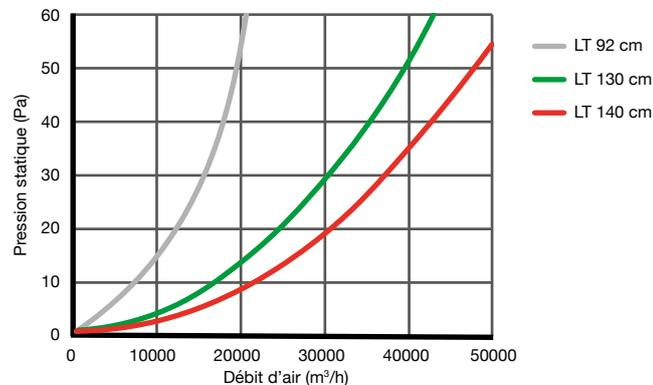
Chute de pression dans le piège à lumière
